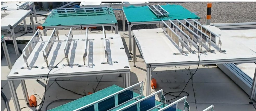
Abbildung 54: Miniaturisierte Teststände aus dem PV-Eye Projekt in welchem die Effekte unterschiedlicher GCRs (0.5 und 1) untersucht werden (Albedo 0.5)
