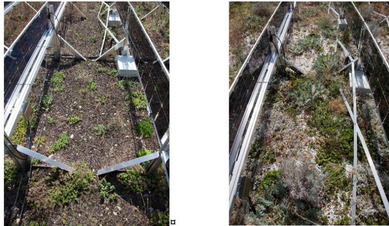
Abbildung 5: Standardbepflanzung (links) und silberlaubige Pflanzen (rechts) nach einer Hitzeperiode auf dem Gründach des Seniorenheims in Winterthur. Die Standardbepflanzung litt unter den harschen Bedingungen wesentlich stärker, wie ein Vergleich mit Abbildung 6 zeigt.
