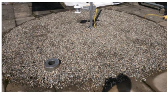
Abbildung 27: Albedomessungen an Substratmaterialien mit unterschiedlichem Rückstrahlverhalten. Die Sprünge in den Verläufen stammen von Abschattungen des Untergrunds oder direkt der Pyranometer.
